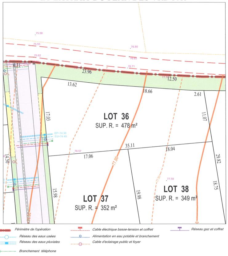
NOTA : - L'emplacement des branchements et la profondeur indiquée sont figuratifs et devront être vérifiés avant tout projet de construction.
