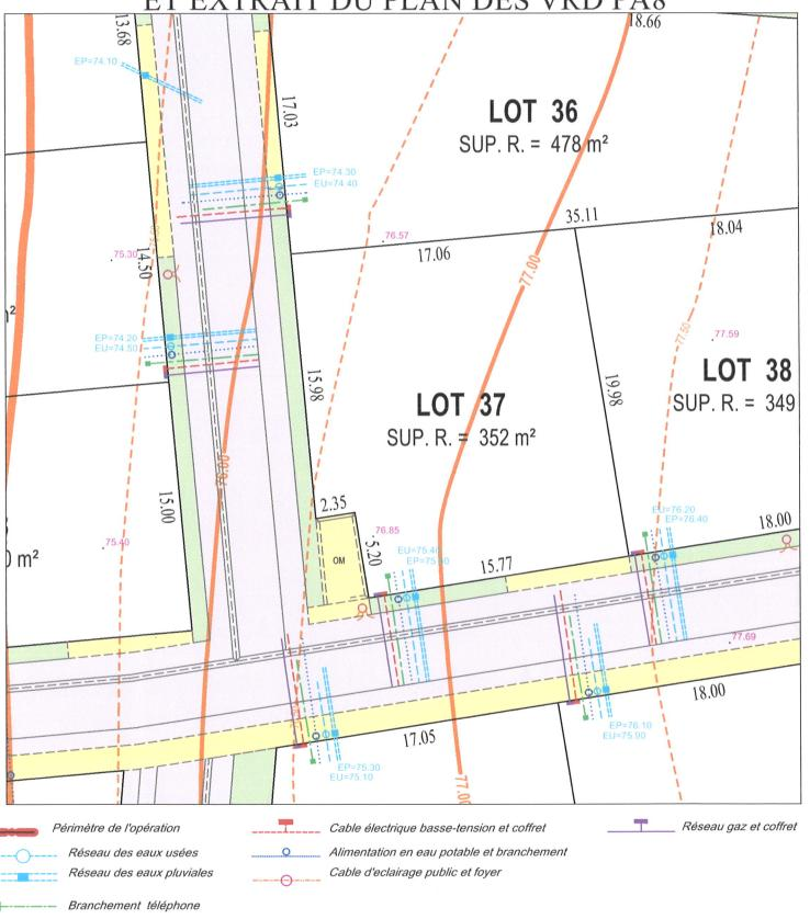
NOTA : - L'emplacement des branchements et la profondeur indiquée sont figuratifs et devront être vérifiés avant tout projet de construction.
